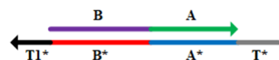
شکل (۱): نمایی از یک دروازه AND طراحی شده با استفاده از تکنیک محاسبات مبتنی بر دنا
