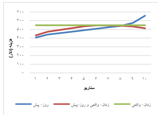
شکل (۱۳): نمودار اثر تغییرات (افزایش/کاهش) قیمت برق در زمان روز - قبل، زمان - واقعی و مشارکت توأم روی هزینه بهره‌برداری ریزشکبه
