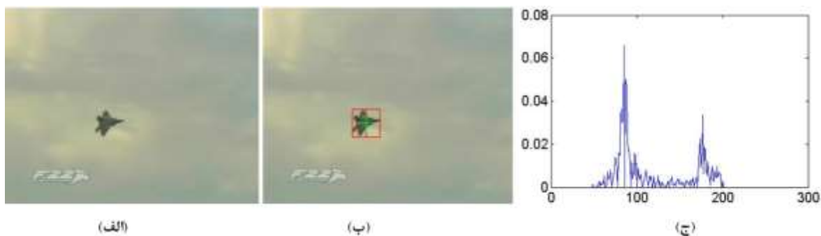
شکل (۸): (الف) جسم موردنظر جهت ردیابی (ب) پنجره محاط بر هدف جهت تعیین مدل هدف (ج) هیستوگرام وزندار شده و نرمالیزه شده مدل هدف
