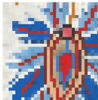
شکل (۱۰): تصویری معادل با شکل (۷) بعد از نگاشت هر خانه به یک پیکسل با کمک حداقل کردن واریانس و تعیین رنگ هر خانه با توجه به مربعی با فاصله ۱ پیکسل از هر خط.
