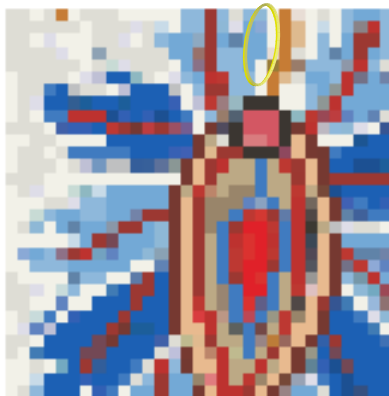
شکل (۸): تصویری معادل با شکل (۷) پس از تک‌رنگ کردن خانه‌های نقشه با روش فیلتر میانه
